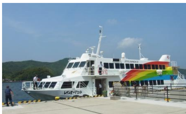
松江と隠岐の間を時速 75kmで結ぶ水中翼
